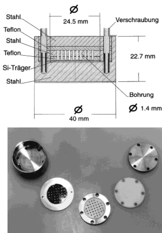
Abb. 1. Konstruktionszeichnung des Vielkammerautoklaven (oben) sowie Foto der einzelnen Autoklaventeile (unten) mit Originalbibliothek (zweite Scheibe von links).
